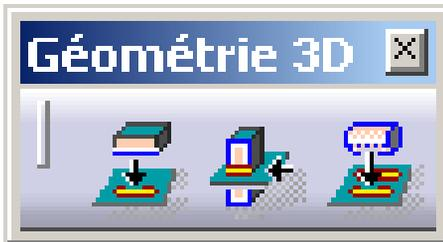
Projection d'éléments 3D sur le plan d'esquisse : projette des arêtes (éléments sélectionnés dans l'atelier Part Design) sur le plan d'esquisse.
