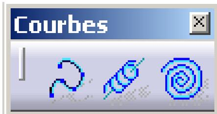
Création de spline : sélectionnez au moins deux points et éventuellement une surface de support. Définissez les conditions de tangence et fermez la spline, si nécessaire.
