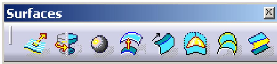
Extrusion de surfaces : sélectionnez un profil, puis indiquez la direction de l'extrusion et les limites de début et de fin.
