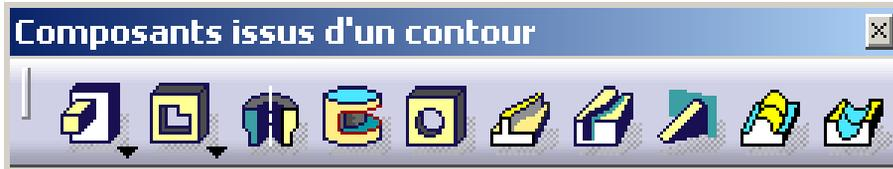
Extrusion : crée un volume par translation d'un contour
