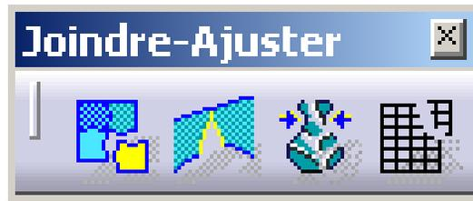
Jonction de géométrie : sélectionnez deux courbes ou surfaces à joindre.
